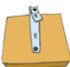
作り方…2cm程の厚さの板を爪切りの横幅の大きさに加工し、刃先を台からはみ出してネジ等で固定します。
